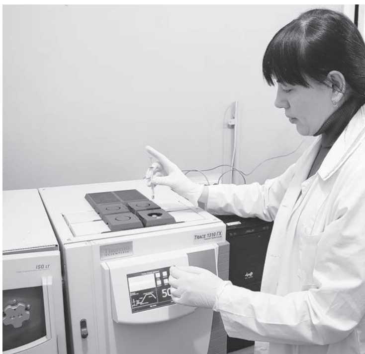
▲ С помощью хроматографа эксперты определяют, является ли изъятое у гражданина вещество наркотическим средством. Для проведения экспертизы нужно микроскопическое количество вещества — одна десятая миллилитра. Анализ выполняется в максимально короткие сроки
