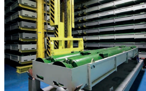
▲ Уникальные ТВС изготовлены в ходе реализации комплексной программы по обоснованию выжигания минорных актинидов в «быстрых» реакторах в рамках развития продуктового направления «Сбалансированный ЯТЦ». Сборкам предстоит облучение в БН-800 Белоярской АЭС и послереакторные исследования.
