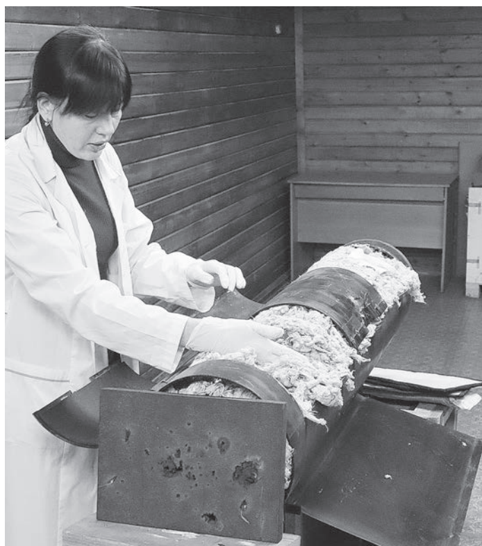
▲ Пулеулавливатель с кевларовыми нитями применяется при баллистической экспертизе.
