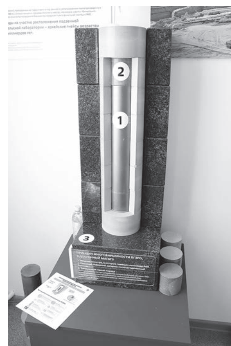
▲ Макет, демонстрирующий контейнер с РАО в «оболочке» из бентонита.
