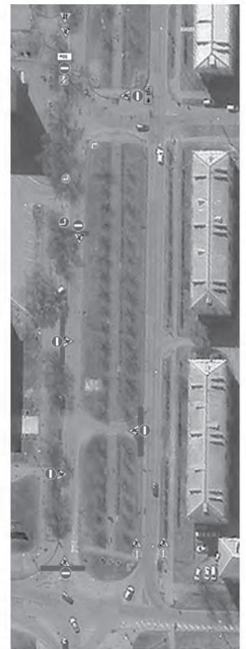
Схема размещения ТСОДД на период временного ограничения движения при проведении капитального ремонта автомобильной дороги общего пользования.
