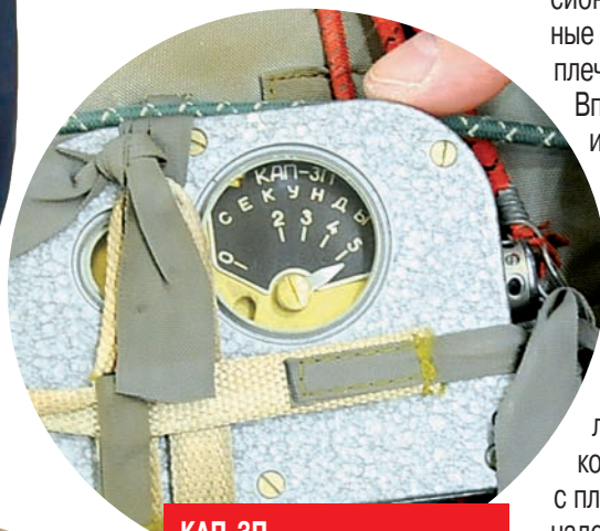
КАП-ЗП - ПОЛУАВТОМАТИЧЕСКИЙ ПРИБОР ДЛЯ РАСКРЫТИЯ ПАРАШЮТА. СРАБАТЫВАЕТ НА ЗАДАННОЙ ВЫСОТЕ, КОТОРУЮ ОПРЕДЕЛЯЕТ БЛАГОДАРИ ДАТЧИКУ ДАВЛЕНИЯ.
